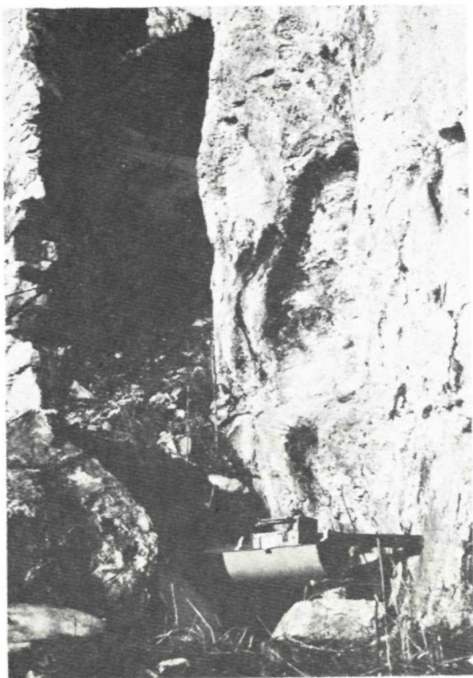
Foto 3. Umiestnenie prístroja P_1 do trhliny bloku Perúnovej skaly Photo 3. Location of instrument P_1 into the crack of Perun rock
